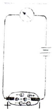
Схема включения ионизационной камеры и движения ионов
